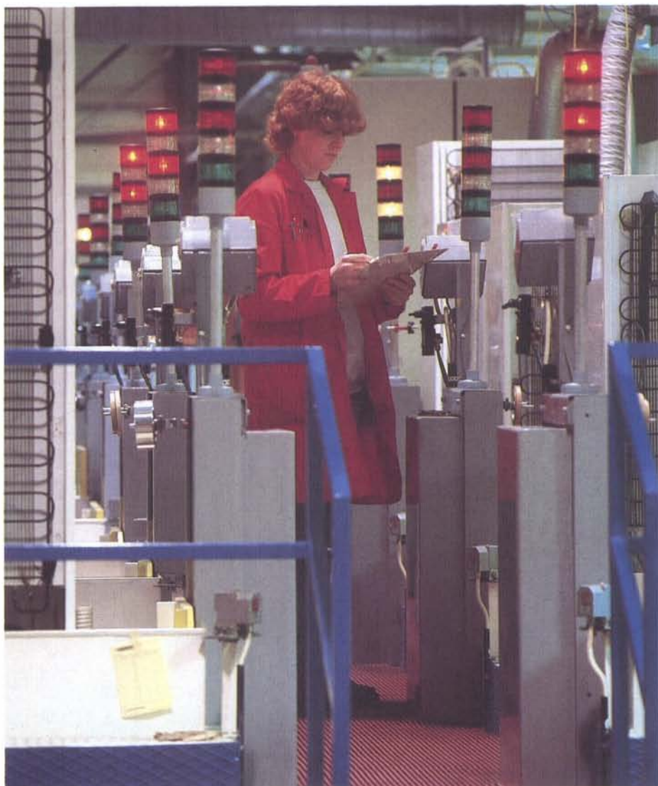
Electrolux stora satsning på kvalitet har under året präglat verksamheten vid de olika produktionsenheterna. Bilden visar datorstyrd provning av kyl- och frysskåp i Mariestads-fabriken.
