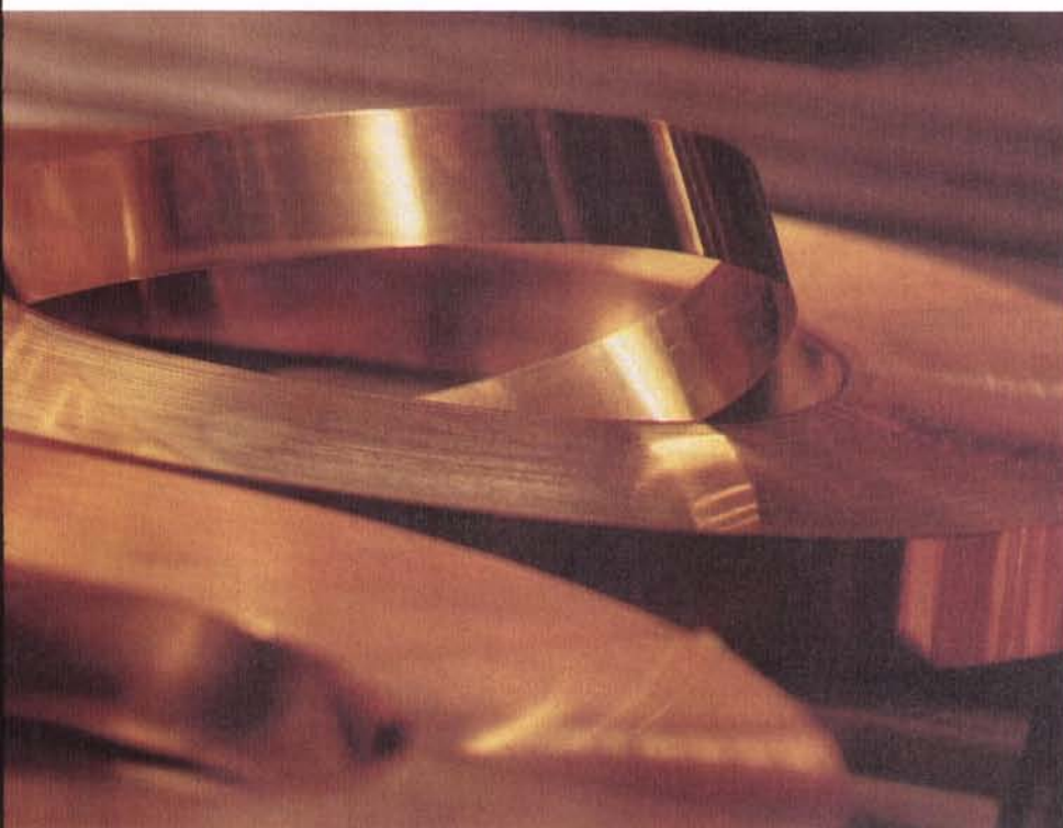
Tunna band i koppar och mässing för främst bilkylare och -värmare är Gränges Metallverkens största exportprodukt. Utvecklingsarbetet siktar till ständigt tunnare dimensioner för vikt- och energibesparing.
