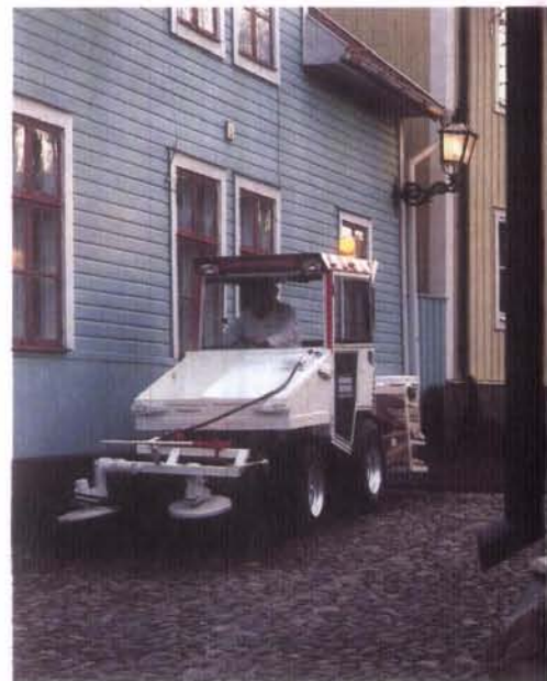
Broddway Universal, som introducerats under året, är en verklig mångsysslare. Den har tillbehör för »allt» från sopning och snöröjning till gödsling och lövsugning.
