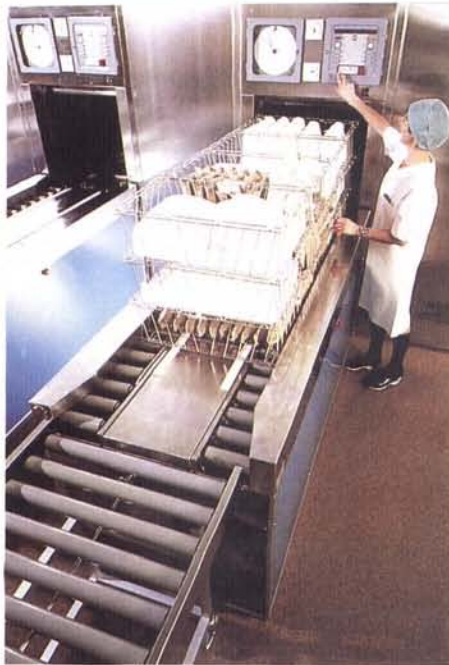
Getinges autoklaver steriliserar instrument med ånga, formaldehyd och etylenoxid allt efter behov.
