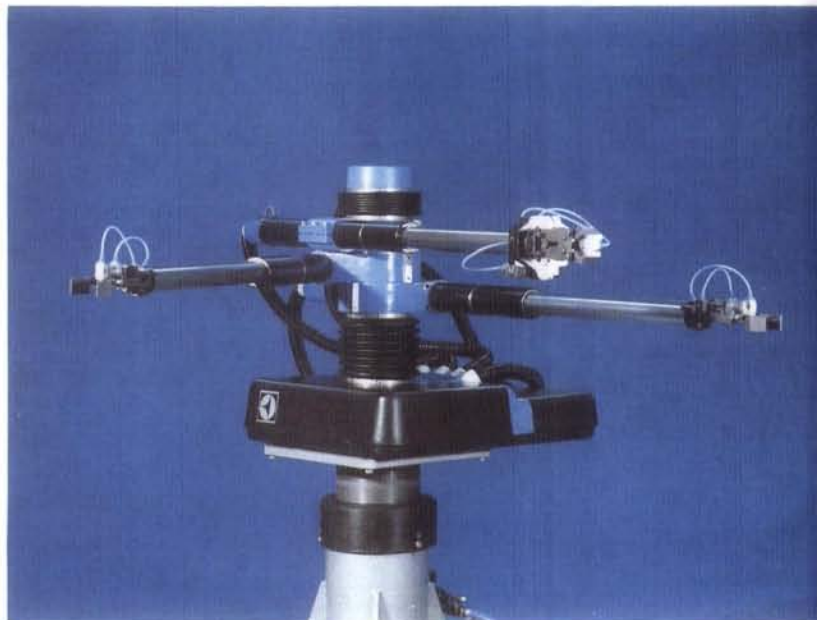
Med Electrolux trearmed industrirobot MHU Junior kan flera bearbetningsmaskiner betjänas samtidigt.
