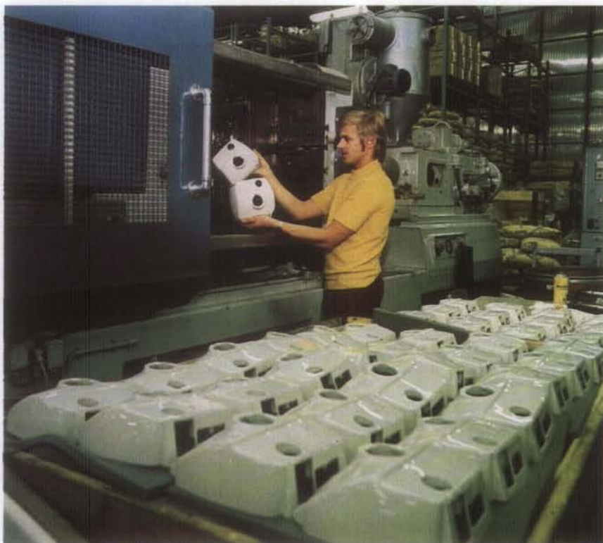
Electrolux-fabriken i Motala har en av Sveriges största anläggningar för formsprutning av plast. Bilden visar tillverkning av dammsugar-kåpor av termoplast.
