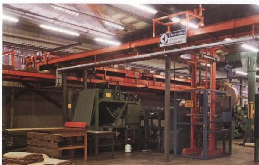
B Vertikallyftare i anslutning till ackumulerade transportbanor. Papperssäckarna lagras automatiskt i väntan på pallastning i säckfabriken enl. principskiss, sid. 18.
