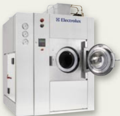
L'LCO2 Dry-Cleaning System, commercializzato a livello mondiale nel 2004, impiega anidride carbonica invece dei tradizionali agenti pulenti per lavare a secco gli indumenti. L'anidride carbonica altamente pressurizzata agisce come solvente efficace e al tempo stesso non inquinante per l'ambiente per rimuovere lo sporco. A fine ciclo, la pressione viene ridotta e l'anidride carbonica distillata e recuperata.
