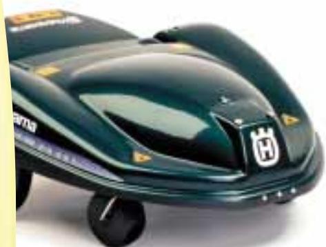
Husqvarnas batteridrivna Auto Mower är en självgående gräsklippare som laddas automatiskt.
