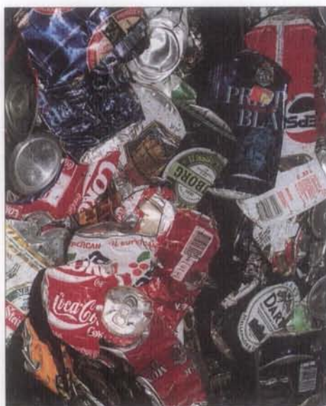
Aluminium som återvinns kan cirkulera i ett nästan oändligt kretslopp. Vid Finspong Aluminium omsmälts varje år cirka 800 miljoner dryckesburkar, som blir bandämnen för nya burkar.
