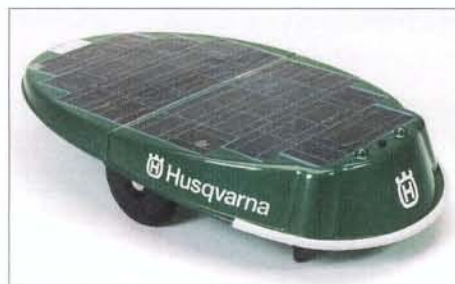
Prototyp av den solcellsdrivna och självgående gräsklipparen Solar Turtle.
